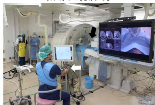
図3. 臨床試験中の様子 医師はCT装置から離れた場所でコントローラ（白矢印）を用いてロボット（黒矢印）を遠隔操作している。
