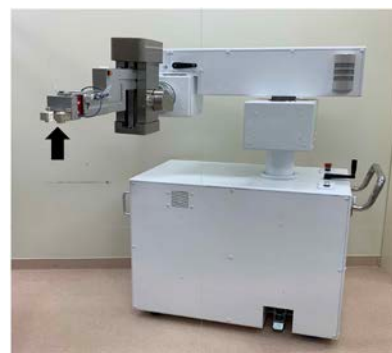
図2. 岡山大学で開発したロボット ロボットアーム先端（矢印）に針を取り付けて使用する。
